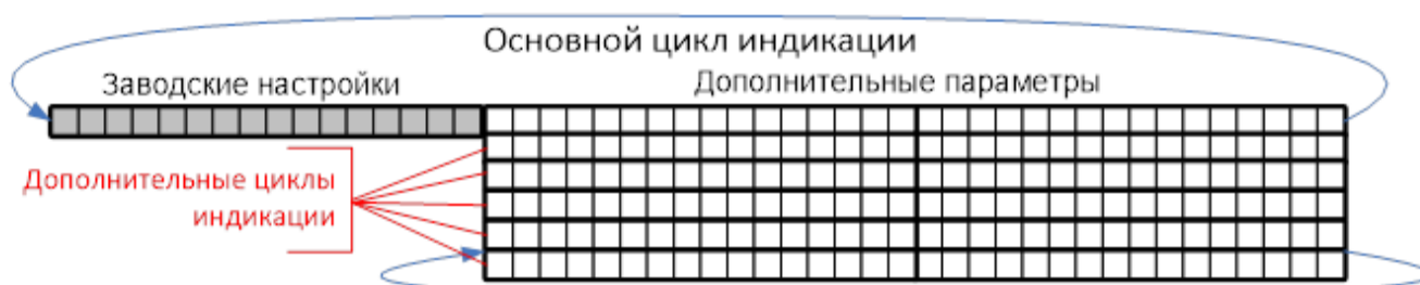
Рисунок 3.5 – Режимы циклической индикации счетчика с символами «A1Rx-xxx-Px-xxx-D»
