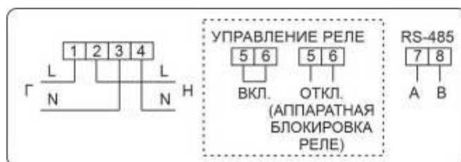
Рисунок Б.34 – Схема включения счетчиков в корпусах W9 с интерфейсом RS-485 и аппаратной блокировкой встроенного реле управления нагрузкой (с помощью клеммника)
