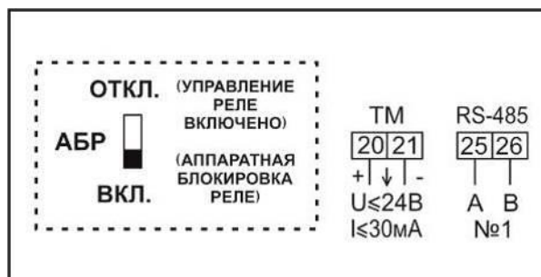
Рисунок Б.13 – Схема включения сигнальных цепей счетчиков в корпусах W37 непосредственного включения с аппаратной блокировкой встроенного реле управления нагрузкой, с одним интерфейсом RS-485, с телеметрическим выходом (ТМ)
