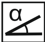
Рисунок 2.1 – Обозначение дополнительного датчика наклона
