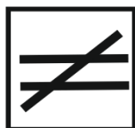
Рисунок 2.4 – Обозначение дополнительного датчика тока в цепи нейтрали
