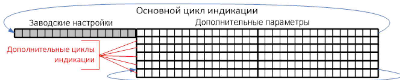
Рисунок 3.5 – Отображение циклов индикации при настройке по протоколу МИРТЕК
