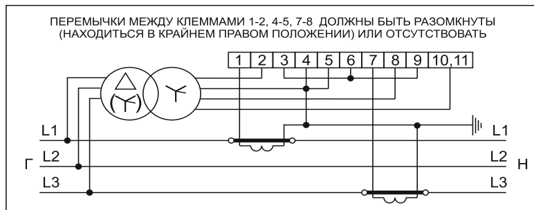
Рисунок Б.10 – Схема включения счетчиков в корпусах W31 трансформаторного включения через три трансформатора напряжения и два трансформатора тока
