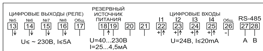
Рисунок Б.45 – Схема включения сигнальных цепей счетчиков в корпусе W32 с интерфейсом RS-485, с четырьмя дискретными выходами (с одним общим проводом) и с четырьмя дискретными входами (с одним общим проводом), с одним входом для подключения резервного источника питания в диапазоне от 40 до 230 В
