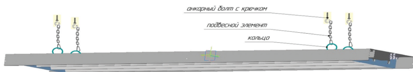
Рисунок 4. Схема подвеса электрообогревателя.
