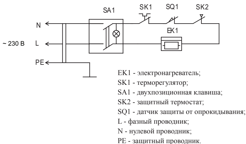
Рис. 3. Схема электрическая принципиальная конвекторов со стич элементом мощностью 1000 Вт модель SW.
