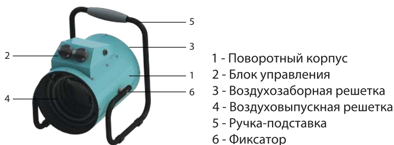
Рис. 1. Устройство прибора
