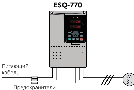
Рисунок 3-23. Схема установки предохранителей.
