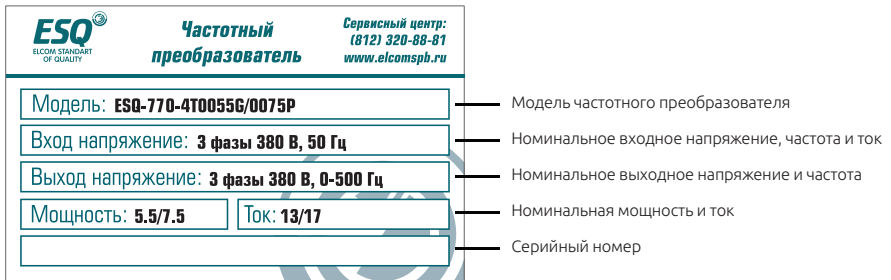
Рисунок 2-4. Изображение шильды частотного преобразователя ESQ-770
