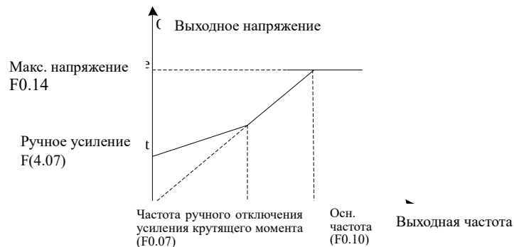
Рис.6-10 Схема усиления крутящего момента
