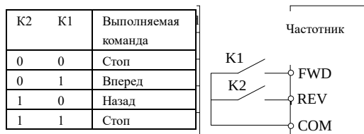
Рис.6-13 Двухпроводной режим управления 1
