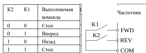
Рис.6-13 Двухпроводной режим управления 1
