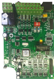
Рисунок 9.5 – Плата управления с покрытием лаком
