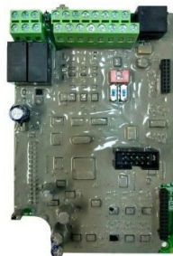
Рисунок 9.4 – Плата управления с покрытием компаундом
