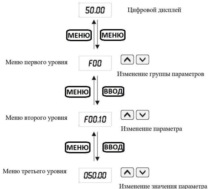
Рисунок 6.1 – Схема настройки параметров меню
