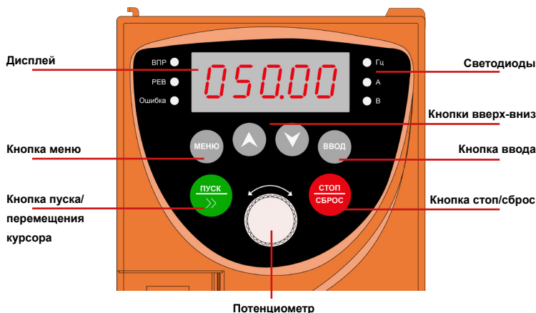
Рисунок 5.1 – Функции кнопок и светодиодов панели управления INVENT
