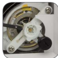
Настройка нулевого положения стрелки
